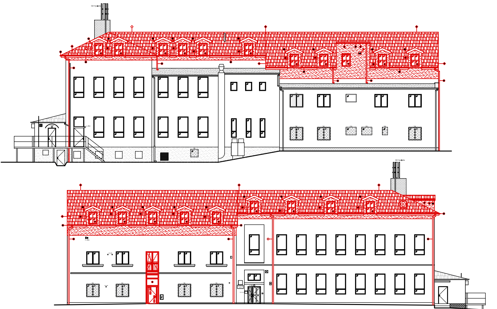
Nadstavba srovná výšku střechy do jedné linie.
